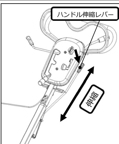
作業条件に合わせてハンドルの長さを15cmの間隔の5段階で固定できます。傾斜面の長さに応じて使い分けてください。
