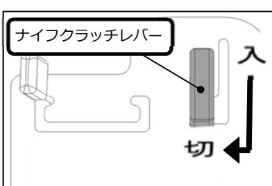
⑧ 作業を終了する場合には、まず主クラッチレバーから手を離し、本機を停止させてください。（遠心クラッチが切れ、ナイフの回転と走行が停止します。）
