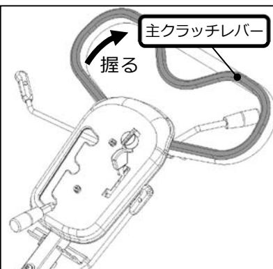
⑥ 主クラッチレバーを徐々にハンドル側に引いていくと、エンジン回転が上昇し、遠心クラッチによりナイフが回転を始めます。
