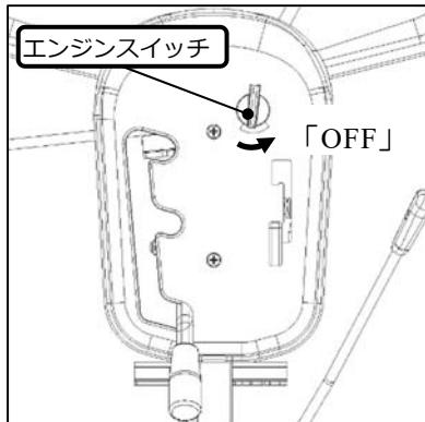
①主クラッチレバーから手を離し、エンジンスイッチを「停止(OFF)」位置にしてエンジンを停止してください。
