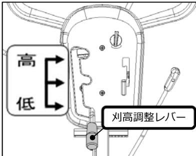
① 作業状況に合わせて刈高調整レバーで刈高さを調整してください。
