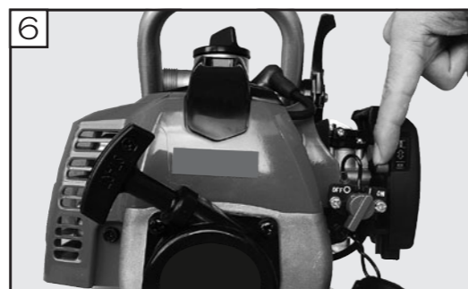
6 始動後、エンジンの調子を見ながら徐々にチョークレバーを全開位置(下側)にします。
