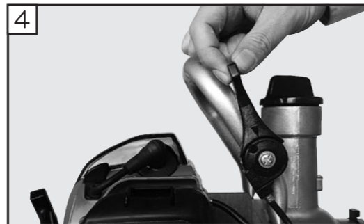
4 スロットルレバーを“低速”の位置と高速位置の半分(中速)まで動かします。
