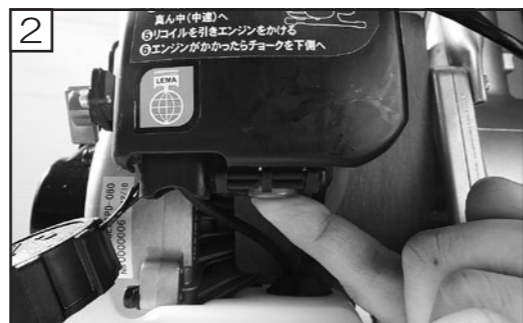
2 プライミングポンプを指で押します。(10回以上) プライミングポンプを押すのは燃料をキャブレターに汲み上げるためです。
