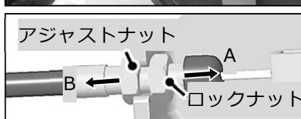
左写真を参考に、デフロックワイヤのアジャストナットで調整し、調整後は確実に作動するか確認してください。
