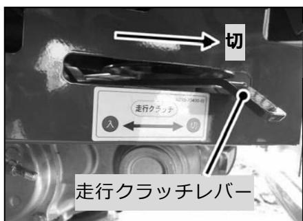
平坦地では、走行クラッチを「切」位置（RM953 は副変速レバー「N」位置）にするとエンジンをかけずに空押ししやすくなります。エンジントラブル時等に使用します。
