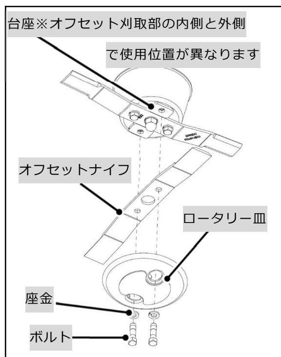
③ 左図を参考に、オフセットナイフを下向きで、ロータリー皿と共にボルトで固定します。この際、ネックガードの台座が付いている穴に取り付けてください。
