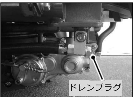
※ 最初の**5時間**、それ以降は**50時間**(オイルフィルタ付)運転毎、もしくはシーズン毎のいずれか早い時期を目安に交換してください。但し負荷の厳しい作業条件や高温環境下での連続作業では、上記時間に達する前、エンジンオイル(約**25時間**毎)及びオイルフィルタ(約**50時間**毎)の早めの交換をお奨めします。
