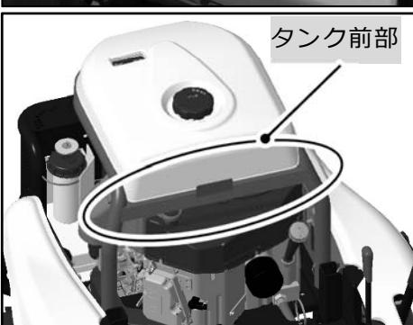
③ 燃料はフィルタの中間以上は入れないでください。路面の凸凹、斜面での燃料漏れの原因となります。漏れ出した燃料はタンク前部へ排出されますが、こぼれた燃料はきれいに拭き取ってください
