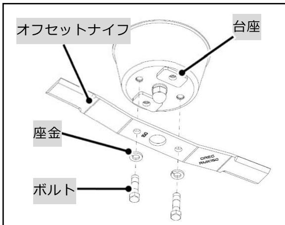
① 左下図を参考に、ロータリー皿の穴からボックスレンチを使用して、バーナイフを固定しているボルトを外します。
