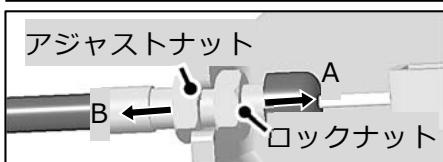
左写真を参考に、デフロックワイヤのアジャストナットで調整し、調整後は確実に作動するか確認してください。
