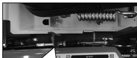
左写真を参考に、ナイフクラッチワイヤのアジャストナットで調整してください。
