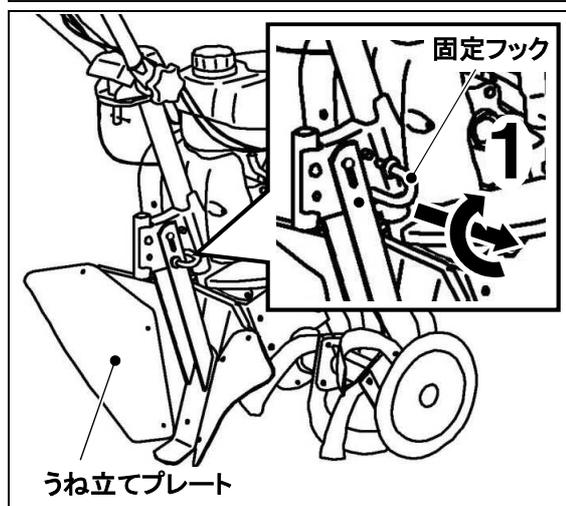
**2** うね立てプレートを上方に回転させて押し込みます。
