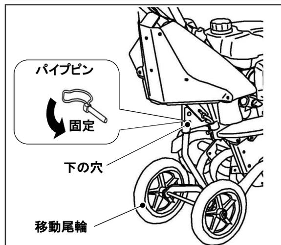
**3** ハンドルを押し下げ、耕うん爪を浮かせた状態で機体を押し引きしてください。（段差のある場合は、スピードを落としてゆっくりと押し引きしてください。）
