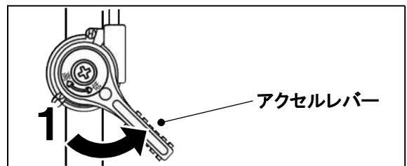
2 エンジンスイッチを押すと自動的に停止側を向き、エンジンが停止します。
