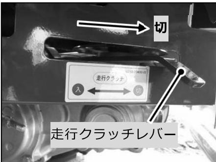
平坦地では、走行クラッチを「切」位置にするとエンジンをかけて空押ししやすくなります。エンジントラブル時等に使用します。
