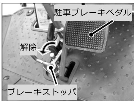
④ 駐車ブレーキペダルを深く踏み込みブレーキストッパーを解除してください。
