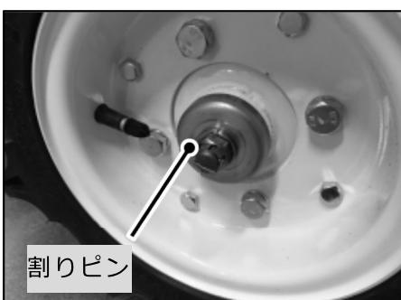
ホイルキャップ、割りピン、ナットを取り外して下さい。点検、清掃を行った後に組付ける際は、割りピンは再利用せず、新品を使用してください。ナットは割りピンを通す穴位置を合わせて締付けてください。
