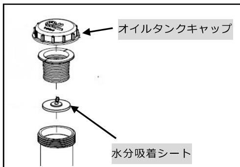
HST オイルタンク内のオイル量を外観から点検し、オイルのレベルが上限と下限との間にはない場合には、オイルタンクのキャップを開け、HST オイルを上限まで補給して下さい。
