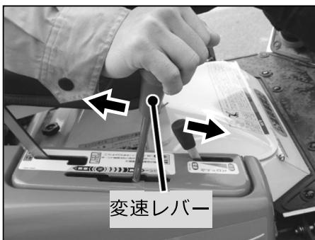
⑤ 変速レバー(チェンジペダル)をゆっくりと前方に倒して(踏み込んで)、本機を前進させてください。
