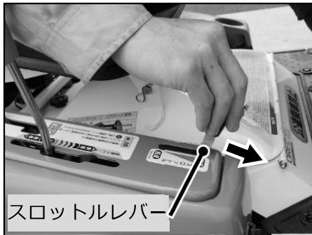
③ スロットルレバーを「高速」側へ倒し、エンジンの回転を上げてください。
