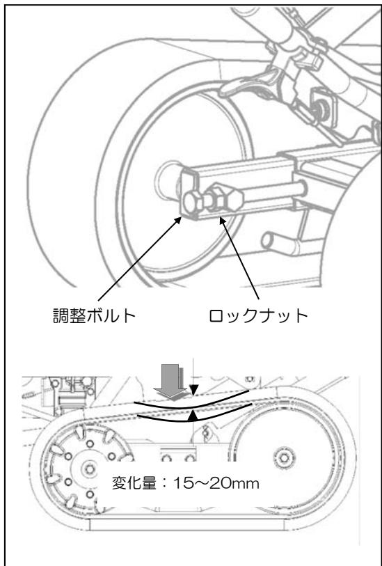
①車体後方の調整ボルトのロックナット（M12）を緩めて下さい。（左右とも）
