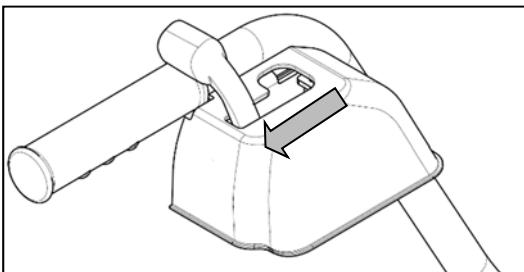
・電源スイッチを「入」にし、コントロールレバーを後進側に倒して下さい。
