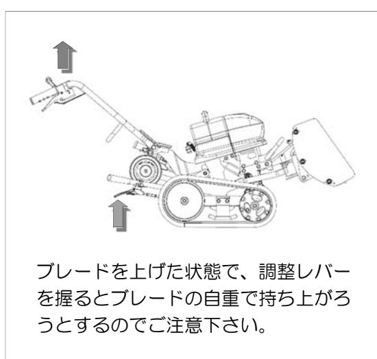
ブレードを上げた状態で、調整レバーを握るとブレードの自重で持ち上がろうとするのでご注意下さい。
