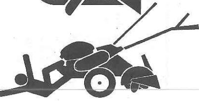
エンジンを始動するときは必ずクラッチレバーを「切」にし、変速レバーを「中立」位置にし、周囲の安全を確認してから行ってください。
