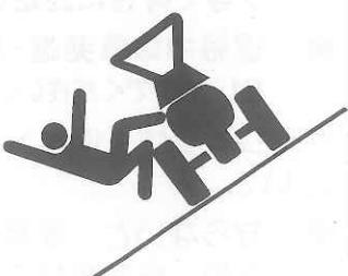
**積み込みのときは変速レバー位置を「低速」、積み降ろしのときは「後進」でエンジン回転を下げてゆっくり行き、デフ切替レバーは必ず「デフ固定／直進」の位置にしてください。**
