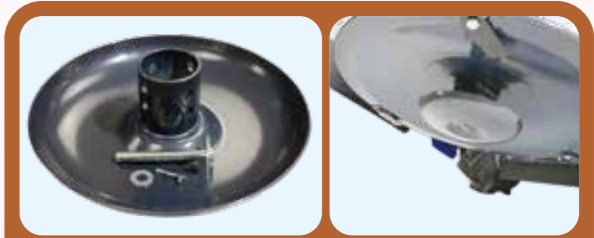
刈高さ調整は、25・40・55・70 (mm) の4段階。ピンを差し替えて調整可能です。刈高さ調整部分は作業部ロータリ下にあります。
