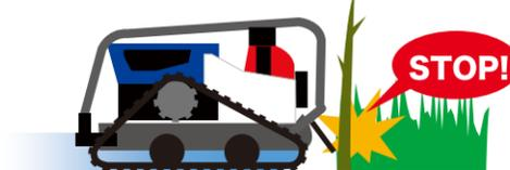
エンジン回転数で高負荷を検知し、ナイフや走行を自動停止します。正常になると自動で作業再開します。
