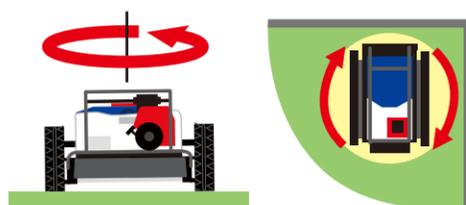
左右のクローラーが逆方向に回転し、その場で旋回(ゼロターン)が可能。狭い場所でもスムーズに方向転換します。
